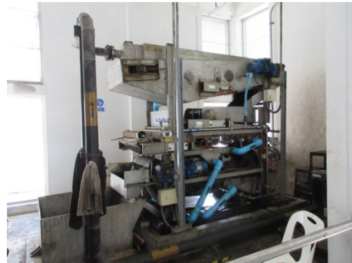
เครื่องอัดตะกอน (Filter Press)
